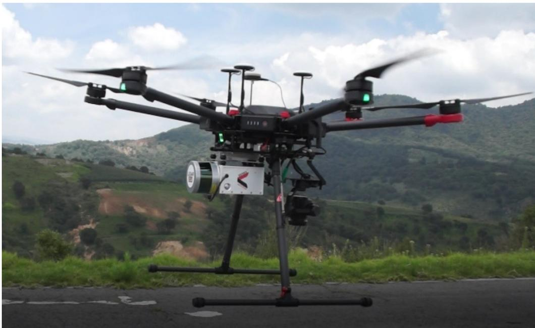
**Vehículo aéreo no tripulado “drone” Matrice 600 Pro con LiDAR y cámara en despegue**
